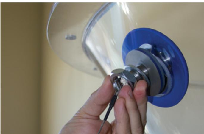
6. Mantendo o cabo de retenção seguro, deslizar a arruela de vedação Fast-Fit™ e a arruela do fluidificador sobre o cabo de retenção e sobre a haste. Em seguida, deslizar a porca sobre o cabo de retenção e atarraxar na haste.
