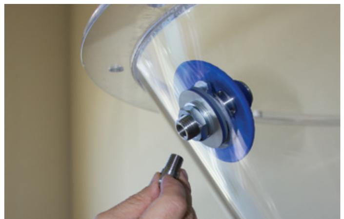
7. Apertar o fluidificador especificado com torque de 35 NM [25 pés lb] e retirar o cabo de retenção.
