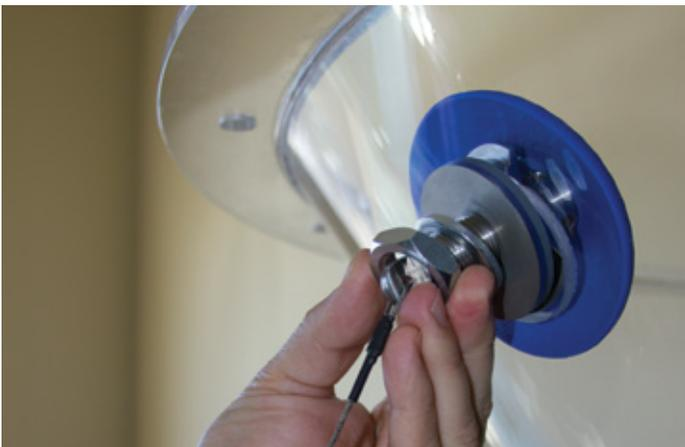
6. Sin soltar el cable de sujeción, pase la arandela de sellado Fast-Fit™ y la arandela del vibrador sobre del cable de sujeción y al vástago. A continuación pase la tuerca sobre el cable de sujeción y ensarte la en el vástago.
