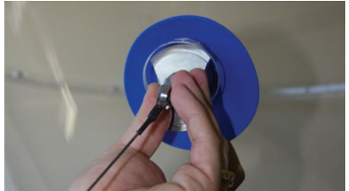
5. Instale la placa de alineación Fast-Fit™ en el cable de sujeción (o en el tubo) y en el depósito con el borde hacia el exterior. Centre la placa de alineación en el agujero de montaje, alineándola en la posición vertical con la flecha apuntando hacia arriba.
