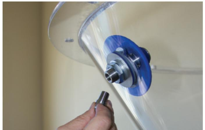
7. Apriete el vibrador al par especificado de 25 lb-pie (35 Nm) y retire el cable de sujeción.
