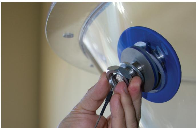
6. Tout en continuant de tenir le câble de retenue, enfiler la rondelle d'étanchéité Fast-Fit™ et la rondelle du fluidiseur sur le câble de retenue et sur la tige. Enfiler ensuite l'écrou sur le câble de retenue et le visser sur la tige.
