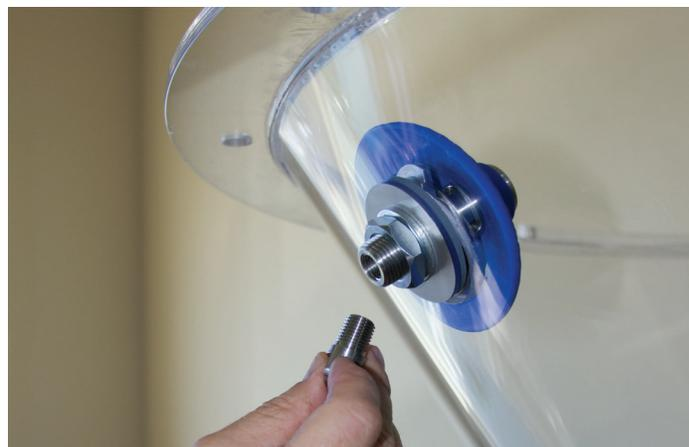
7. Serrer au couple de 35 Nm (25 ft.lb) spécifié pour le fluidiseur puis détacher le câble de retenue.
