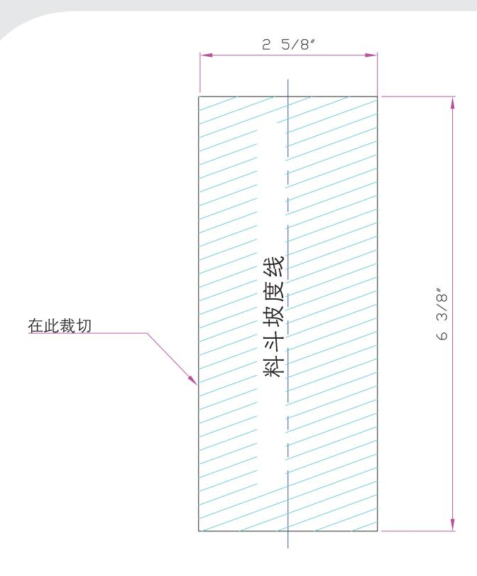
裁切模板 E-Z In(易入)流化器改造 配合套件(圆形)
